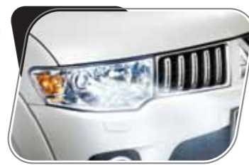
HID Headlamp ไฟหน้าแบบ HID ให้ความสว่างมากขึ้น พร้อม Auto Levelling ระบบปรับระดับลำแสงไฟหน้าอัตโนมัติ และ Headlamp with Auto Lighting Control ระบบควบคุมการเปิด-ปิดไฟหน้าอัตโนมัติ ตามสภาพแสงภายนอก (เฉพาะรุ่น GT)
