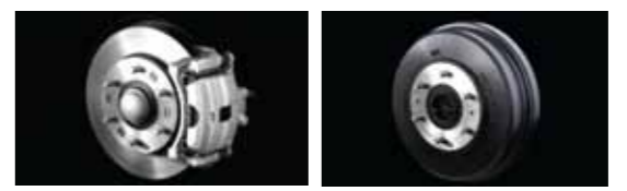
ระบบ DISC BRAKE หน้า ระบบ DRUM BRAKE หลัง
