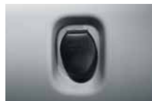
ช่องจ่ายกระแสไฟ 12 โวลต์ สำหรับผู้โดยสารตอนหลัง
