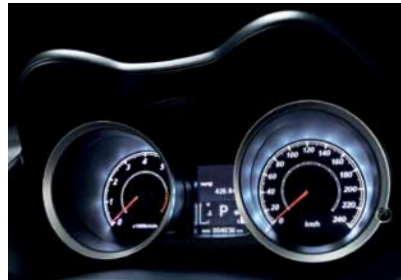
มาตรวัดแบบ Hi-Contrast และจอแสดงผลข้อมูล เอนกประสงค์ (Multi-Information Display)
